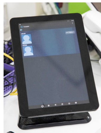
▲ 顔認証システムが検知すると病棟設置のタブレットに患者様の情報が表示される
